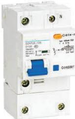
GYM16LE-125漏电断路器适用于交流50Hz, 额定电压单极两线, 两极230V, 三极、三极四线、四极400V, 额定电流至63A~125A的线路中, 当人身触电或电网泄漏电流超过规定值时, 剩余电流动作断路器能够在极短的时间内迅速切断故障电源, 保护人身及用电设备的安全, 同时可以保护线路和电动机的过载或短路, 亦可作为线路的不频繁转换及电动机的不频繁起动之用。产品符合GB14048.2-2008《低压开关设备和控制设备低压断路器》和IEC60947-2: 1997标准。
