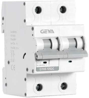
GYH8-125DC隔离开关主要适用于直流 50Hz, 额定电压至 1000V, 额定电流 125A 及以下的配电和控制电路中, 主要作为终端组合电器中的总开关, 也可用于不频繁控制各类小功率电器和照明。
