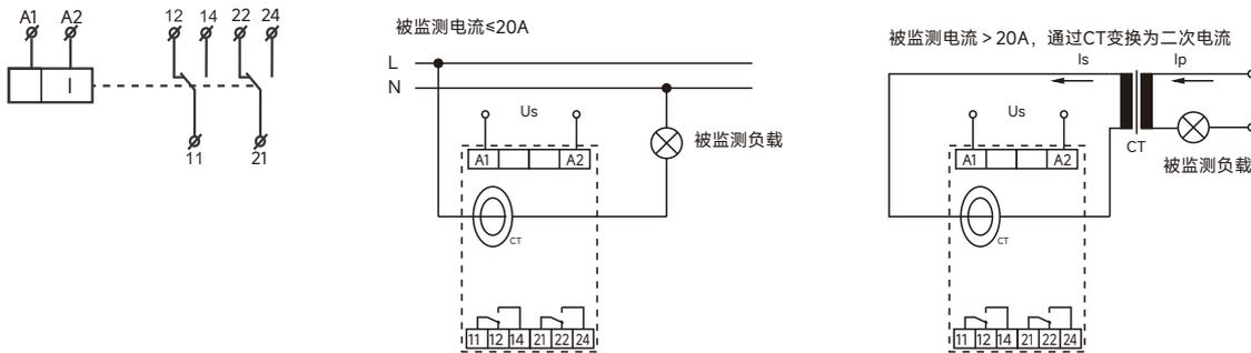
注：GR18-06B检测直流时注意穿心方向，否则无法准确检测，如电流小于2A，可以采用多次穿心的方式。
